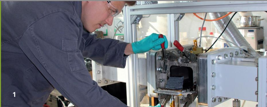
1 Positionierung der Proben aus carbonfaserverstärkten Kunststoffen (CFK) und Verschluss der Mikrowellenpyrolysekammer vor Versuchsbeginn.
