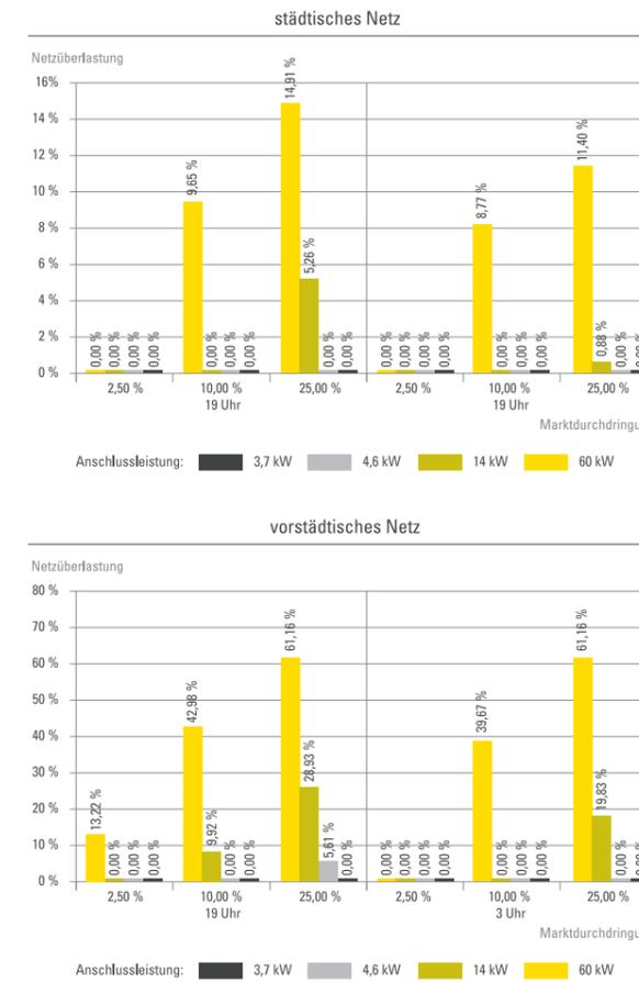
Abbildung 4.12: Potenzielle Netzüberlastungen in Abhängigkeit von unterschiedlichen Ladeleistungen und unterschiedlichen Tageszeiten für verschiedene Durchdringungsraten von Elektrofahrzeugen<sup>1</sup>
