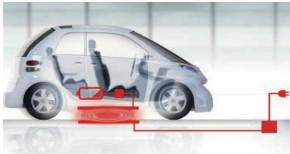
Abbildung 2.11: Induktives Ladesystem der Firma SEW<sup>1</sup>
